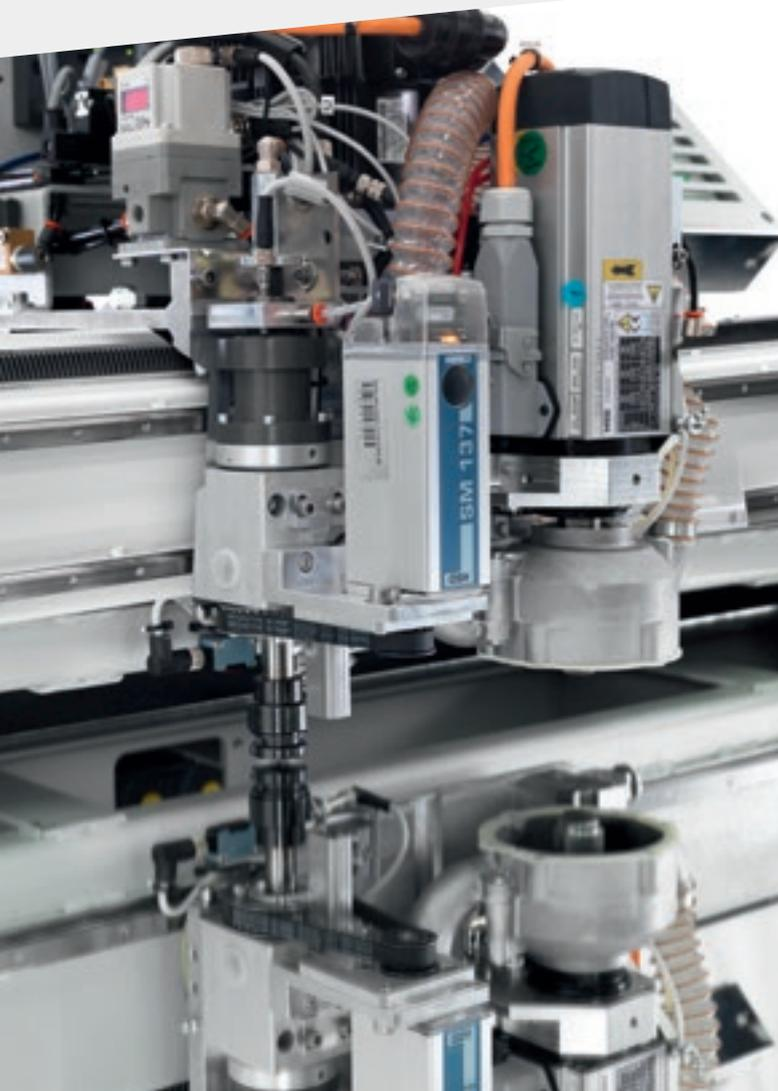
A Genius CT-RED é capaz de executar a remoção da baixa emissividade (Low-E) graças a dispositivos opcionais especiais para cada necessidade de fabricação específica.
